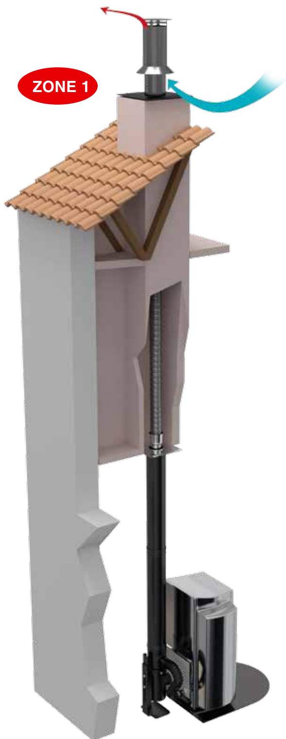
Configuration conduit existant
