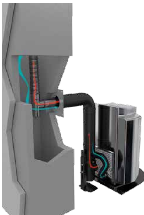
Rénovation avec prise d'air frais haute
